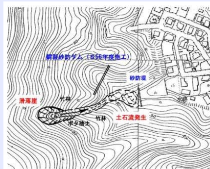
人家に接近する土石流
